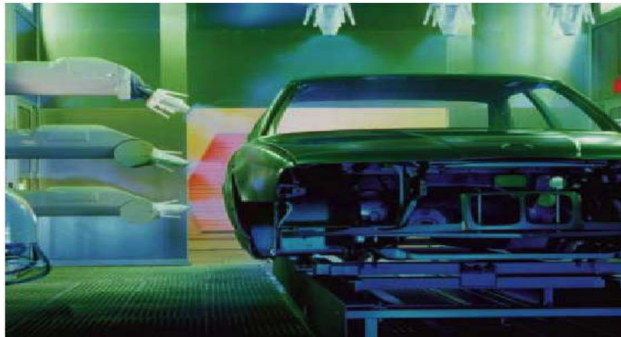
Máquina convencional de pintado mediante pulverizadores electrostáticos fijos
